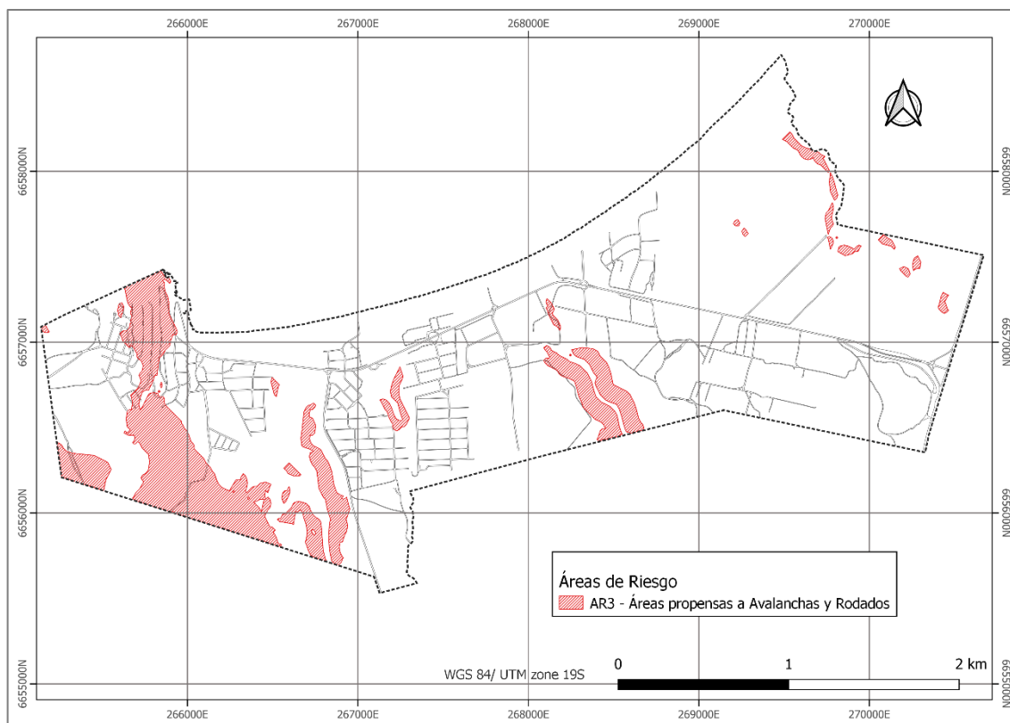
Figura 5-33 Áreas propensas a Avalanchas y Rodados (AR-3), Localidad de Guanaqueros. Fuente: Elaboración propia.
